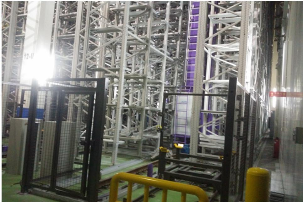
货架的设计是立体仓库设计的一项重要内容，它直接影响到立体仓库面积和空间的利用率。①货架形式：货架的形式有很多，而用在自动化立体仓库的货架一般有：横梁式货架、牛腿式货架、流动式货架等。设计时，可根据货物单元的外形尺寸、重量及其它相关因素来合理选取。②货格的尺寸：货格的尺寸取决于货物单元与货架立柱、横梁（牛腿）之间的间隙大小，同时，在一定程度上也受到货架结构型式及其它因素的影响。堆垛机堆垛机是整个自动化立体仓库的设备，通过手动操作、半自动操作或全自动操作实现把货物从一处搬运到另一处。它由机架（上横梁、下横梁、立柱）、水平行走机构、提升机构、载货台、货叉及电气控制系统构成。③堆垛机形式的确定：堆垛机形式多种多样，包括单轨巷道式堆垛机、双轨巷道式堆垛机、转巷道式堆垛机、单立柱型堆垛机、双立柱型堆垛机等等。④堆垛机速度的确定：根据仓库的流量要求，计算出堆垛机的水平速度、提升速度及货叉速度。⑤其它参数及配置：据仓库现场情况及用户的要求选定堆垛机的定位方式、通讯方式等。堆垛机的配置可高可低，视具体情况而定。输送系统根据物流图，合理选择输送机的类型。
